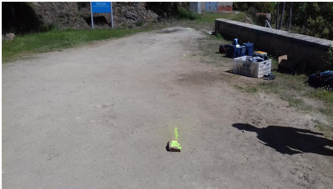
Figura 7. Detalle de una de las marcas realizadas in situ para identificar el trazado de la tubería detectada mediante geo-radar y detector radiofrecuencia.
