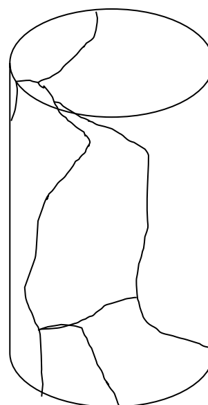
Forma de rotura de la probeta
