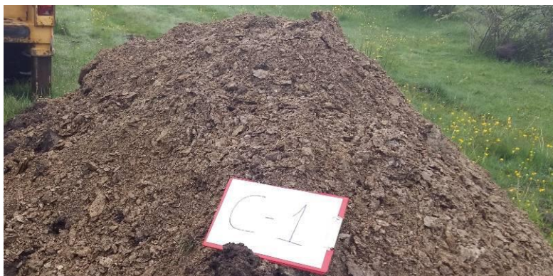
Imagen-25: Material excavado en calicata C-1 correspondiente a esquistos y paragneises con grado de alteración V-VI.
