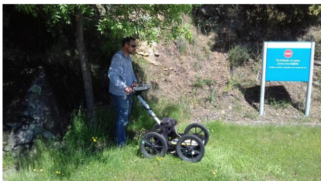
Foto 7.- Detalle de la detección de la tubería objeto de estudio mediante geo-radar .
