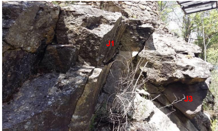
Imagen-38: Macizo rocoso con detalle de juntas: J3 y J1
