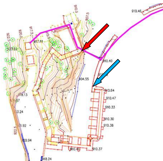
Imagen-21: Localización de la perforación Hilti (flecha azul) y de la estación geomecánica (flecha roja)
