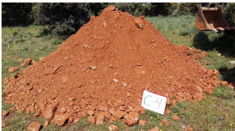
Imagen-26: Material excavado en calicata C-4 correspondiente a los suelos denominados “raña”
