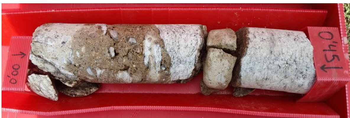
Imagen-28: Testigo extraído sobre la coronación del muro del azud, próximo a las compuertas
