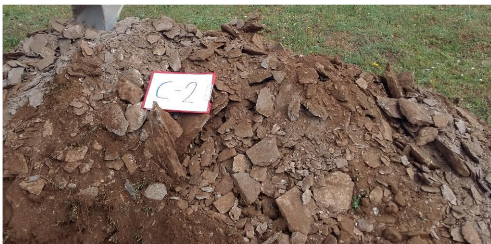
Imagen-24: Material excavado en calicata C-2 correspondiente a esquistos y paragneises con grado de alteración IV
