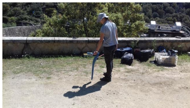
Foto 6.- Detalle de la detección mediante buscacables de la tubería objeto de estudio.
